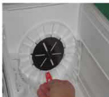
Fiksirani ležaj zaključajte umetanjem crvenog ključa
