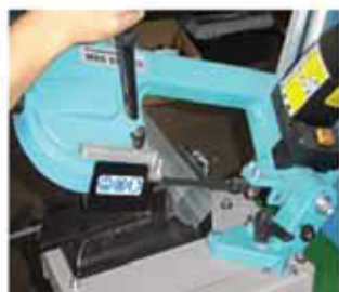
Rezanje osovine (70mm kraća) od prozora
