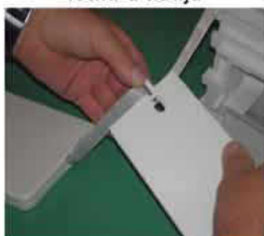
Postavite uvodnik kaiša u predhodno pripremljeno mjesto u donjem profilu
