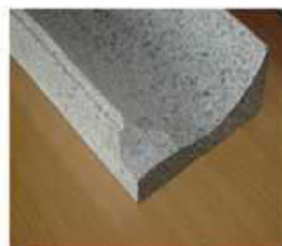
Isjeći izolacijski stiropor
