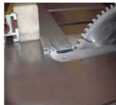
Odrežite završnu šipku komarice na željenu dužinu ovisno o setu komarice
