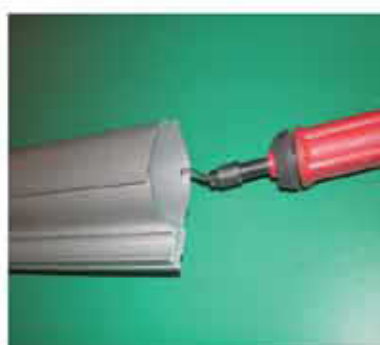
Očistiti ulaz zaštite komarice
