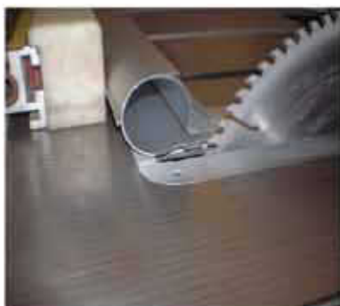
Odrežite zaštitu komarice na željenu dužinu
