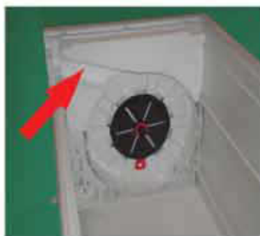
Postavite stiropor izolaciju
