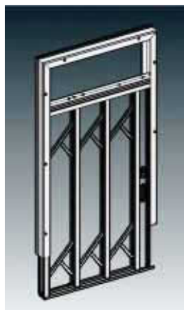
Prikaz kućišta koje se rešetka postavlja kada nisu adekvatni uvijeti štokova.
