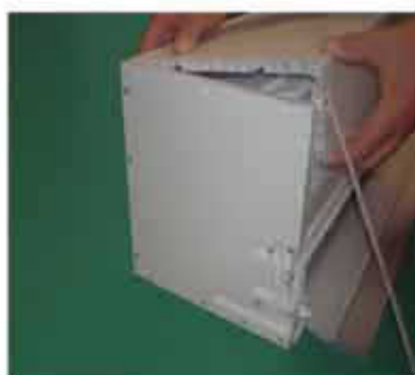
Dodajte unutarnji i donji profil na kutiju
