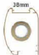
Presjek komarice bez dekla Presjek sa deklom 43mm
