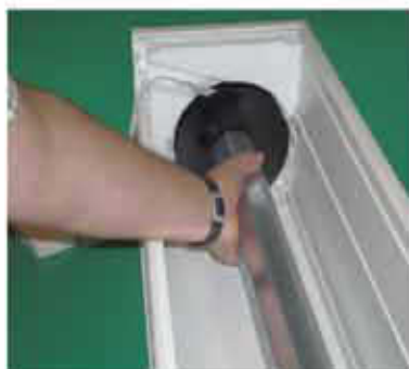
Postavite osovinu sa trakom na predviđenu stranu
